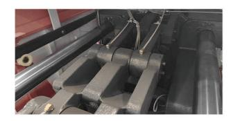
◆ 连杆机构、移模导向套润滑:自动稀油润滑泵+检知式分配器, 便捷、美观。
