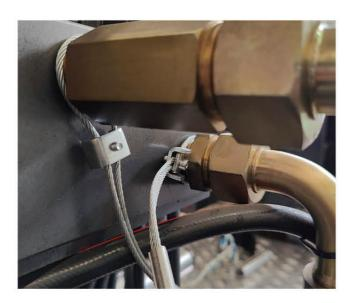
◆ 非焊接管路,杜绝漏油更清洁: 非焊管路 + 高精密旁路过滤装置 + 自封式吸油过滤器 + 整体式油缸总成,提升油液清洁度。新油路设计,外观新颖靓丽,内在油路快而稳。
