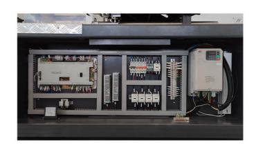
◆ 专业电气布局及品牌元器件: 防水防尘密封电气箱, 采 用世界著名品牌元器件, 强弱电分开布局, 保证设备运 行可靠、控制精准和使用方便。
